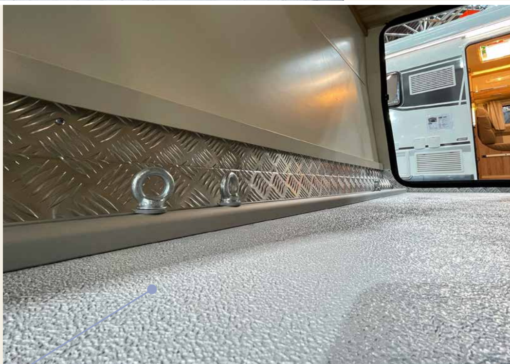
GRP soluzione Vetroskin Levant per i paviment Vetroskin Levant GRP solution for floors
